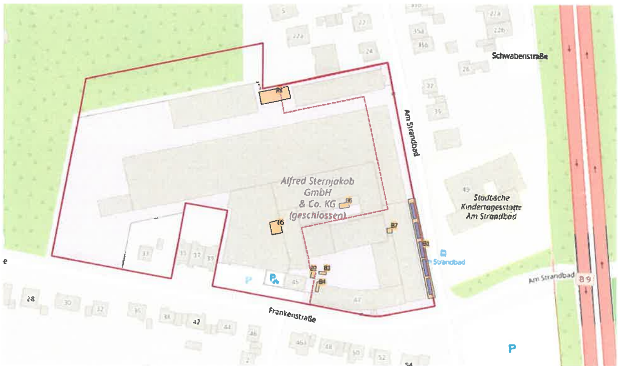
Abbildung 1: Sternjakob-Areal in Frankenthal mit Kennzeichnung der altlastrelevanten Bereiche B1 bis B8
