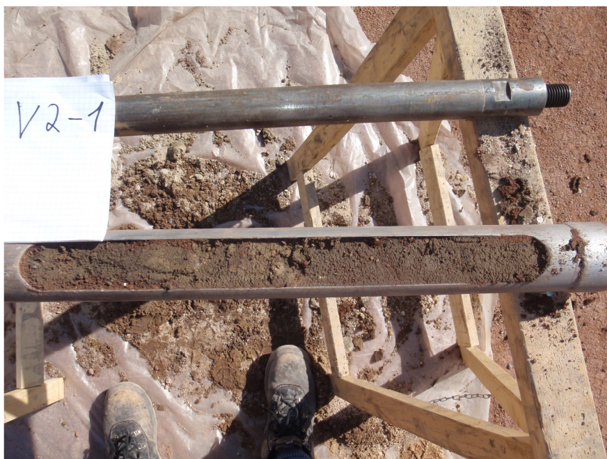
Bild 4: Das im Erdplanum (0,4 m – 1 m) erbohrte, geringfügig fremdstoffhaltige Auffüllmaterial kann aufgrund der schluffig-tonigen Komponenten ( \leq 0,063 mm) den Boden- gruppen SU*/ST* nach DIN 18196 zugeordnet werden (Schluffe, Sande, stark schluffig, sehr frostempfindlich, F3 lt. ZTVE-StB 94/97):
