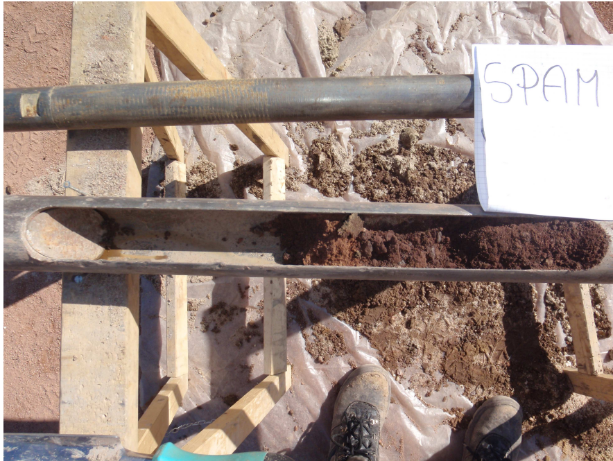
Bild 3: Im Hinblick auf die Filterstabilität der Tennenschicht zu dem Dynamischen Schichtmaterial und zu der Tragschicht (Schotter) ist derzeit nicht von Daten auszugehen, die dem aktuellen Standard im Sportplatzbau entsprechen. Tendenziell waren deutliche Durchmischungen der Tennenschicht und der Dynamischen Schicht sowie der Tragschicht zu beobachten.
