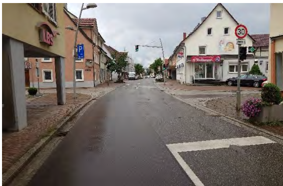
Abbildung 45: Beispiel für eine Wiederholung der Ampelanlage vor einem Kreuzungsarm
